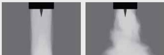
Die Abbildung auf der rechten Seite zeigt einen stark verwirbelten Gasstrom, der eine schlechte Abschirmung und einen erhöhten Gasverbrauch zur Folge hat.
